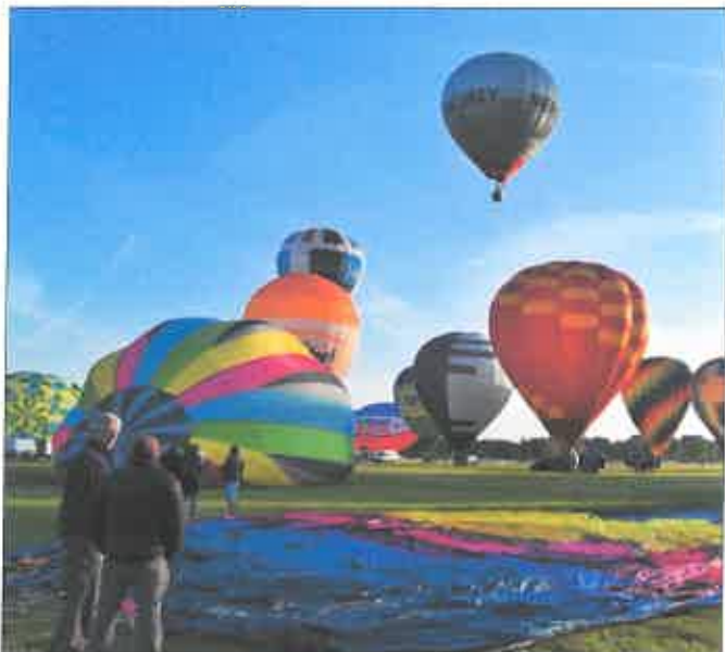
■ Avant de gonfler son enveloppe, l'aérostat s'étale toujours sur le sol dans le sens du vent. Cela se fait une fois qu'il a installé le brûleur sur la nacelle. Photo Grégory JACOB
